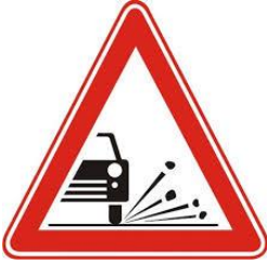
Gevşek malzemeli zemim uyarı işareti
