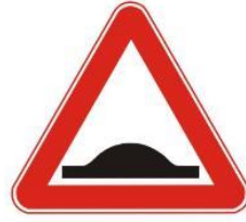
Kasisli köprü yaklaşımı uyarı işareti
